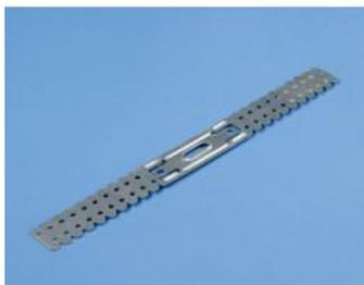
La suspente U de Knauf, en acier galvanisé, complète la gamme d'accessoires de suspension de plafond non démontable, en plaques de plâtre, sur ossature métallique. Elle est destinée à la fixation par vissage de fourrures F47 en plafond Knauf Métal.
